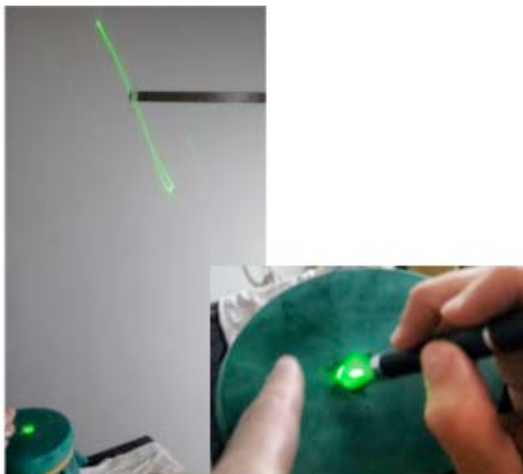
Figura 5: Aparato isolado para geração das imagens sonoras. À direita, detalhe do laser apontado para a superfície refletora. À esquerda, resultado da reflexão enquanto a membrana vibra. Fonte: arquivo pessoal do autor.
