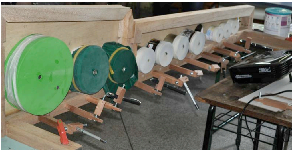
Figura 1: Artefato para manipulação do som e da luz, composto por latas com membranas esticadas, cada qual com espelhos colados onde são apontados feixes de luz gerado por
